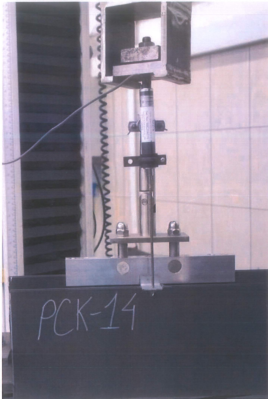
Рисунок 2. Образец в испытательной машине
