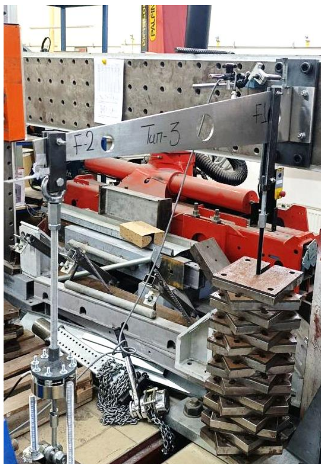
Рисунок 2. Образец Тип 3 в испытательной установке в процессе испытания
