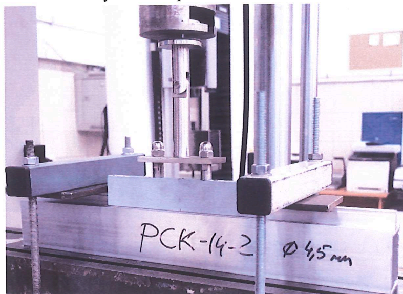
Рисунок 3. Образец в испытательной машине до испытания
