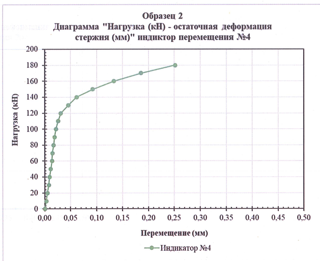
Рисунок 9. Диаграмма "Нагрузка (кН) – остаточная деформация стержня (мм)" для образца 2
