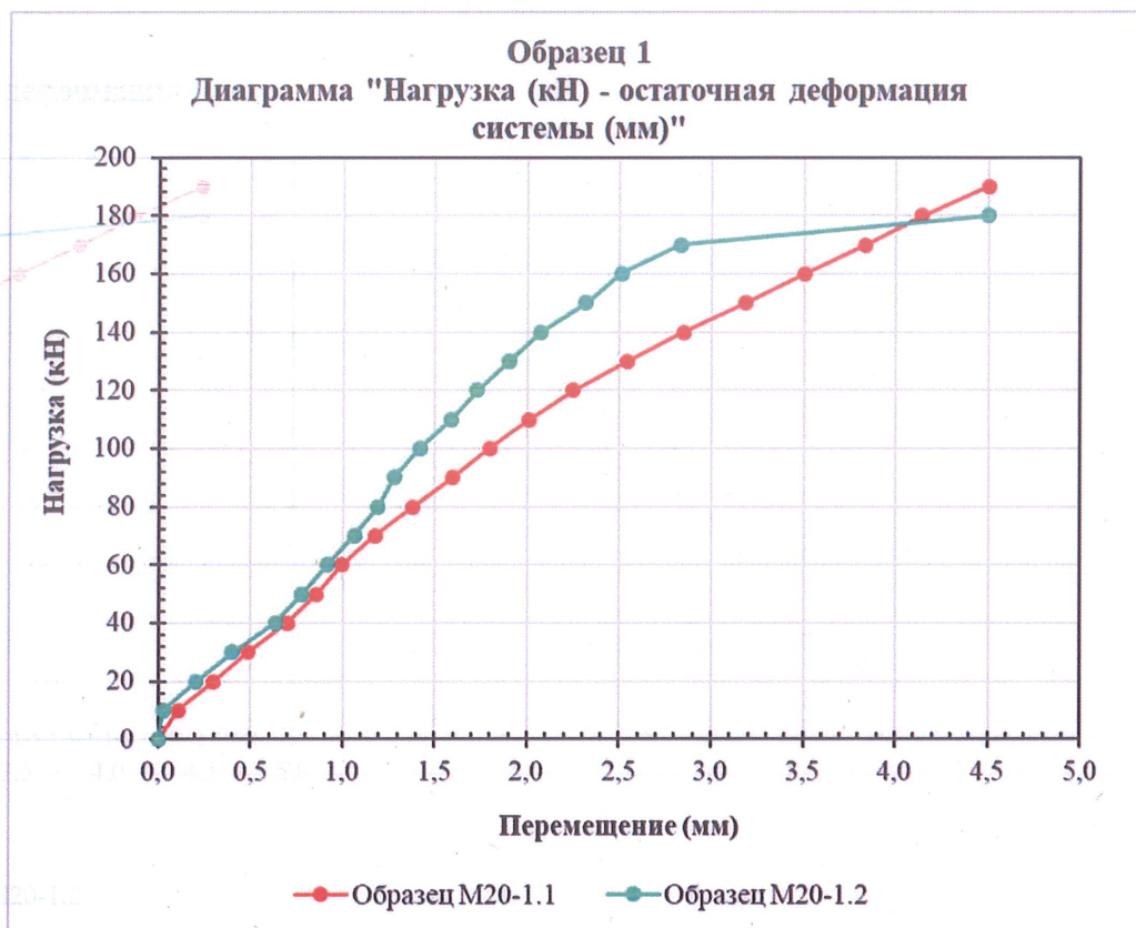
Рисунок 6. Диаграмма "Нагрузка (кН) – остаточная деформация системы (мм)" для образца 1
